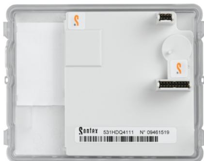
Eichplomben / Calibration seals Ab Werk plombiert - Ex factory sealed Klebeplomben / Sticker seals
